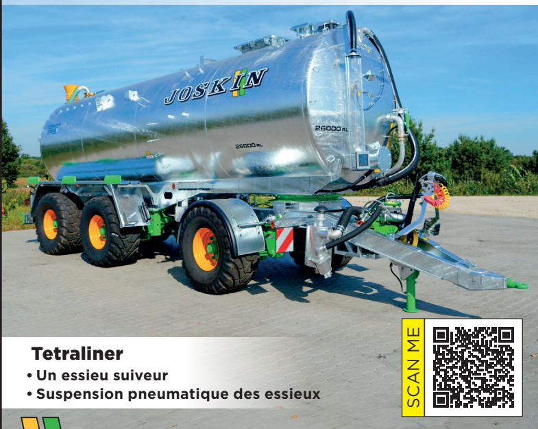
Tetraliner : Dolly et suspension à air
